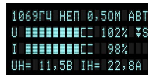
Рисунок 6.2 – режим ограничения по мощности (▼S)
