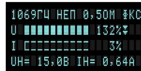
Рисунок 6.1 – режим ограничения по напряжению (▼)
