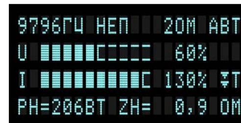
Рисунок 6.4 – режим ограничения по температуре (▼T)
